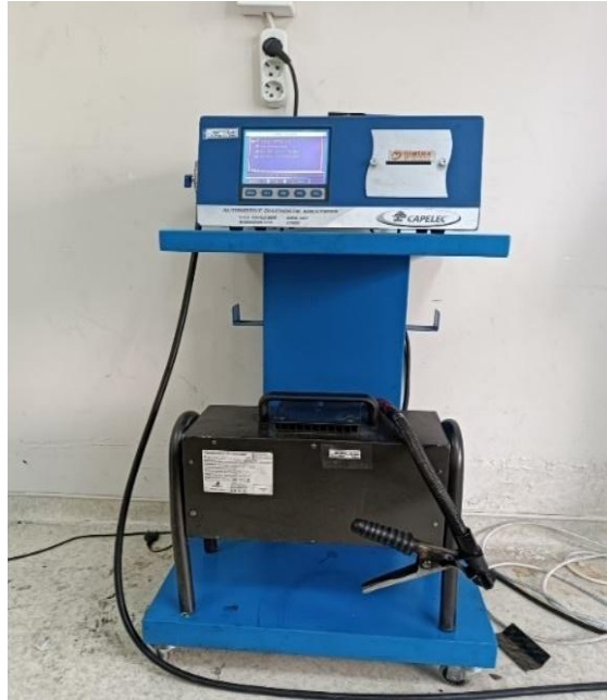
Şekil 4. Egzoz emisyon cihazı ve duman ölçer
